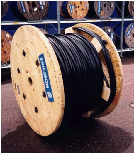
Beispiel von einem Ersatzkabel auf einer Trommel mit einem langen inneren Ende
