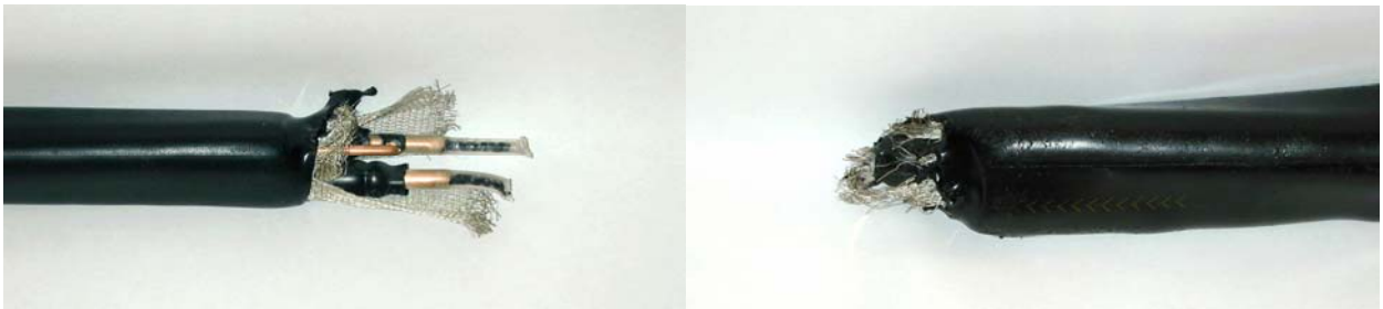
Bruchstellen von EXCEL und AXCES™. Bruchstellen sind begrenzt
